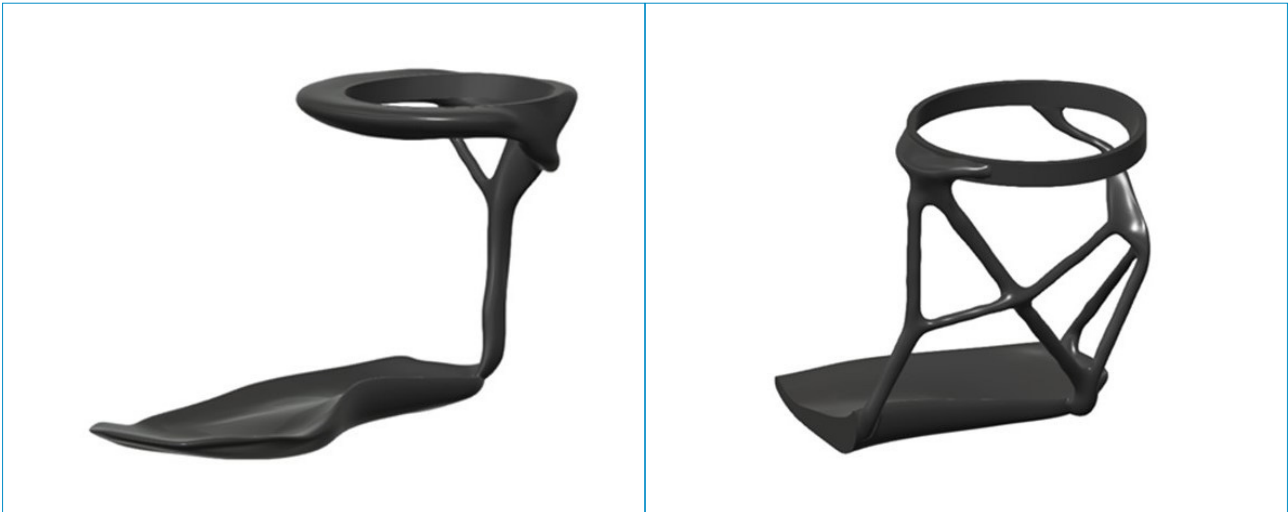
Abbildung 5: Strukturoptimierung von Stützstrukturen (eigene Darstellung)
